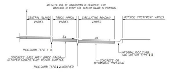
TYPICAL SECTION - ROUNDABOUT CIRCULATING ROADWAY
